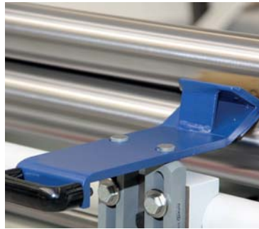
Option: Geifenführung zum Konischrunden (notwendig bei Trichterherstellung)
