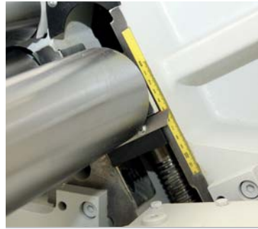
Standard: Zusätzliche Positionsanzeige der Hinterwalze über Skala. Skala ist sowohl auf dem linken, sowie rechten Seitenschild montiert.
