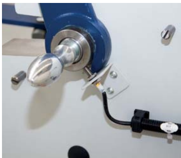
Option: Bei Option Wechselwalze wird der Oberwalzendurchmesser automatisch über einen Initiator erkannt.
