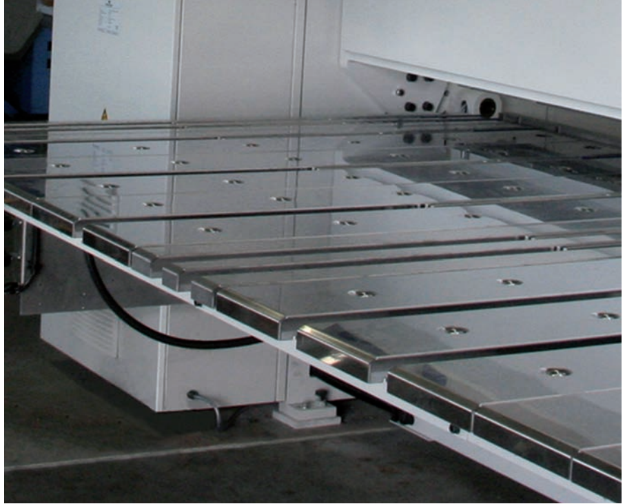
1 600-mm-Anschlag geschlossen mit Kugelrollen im Tisch
