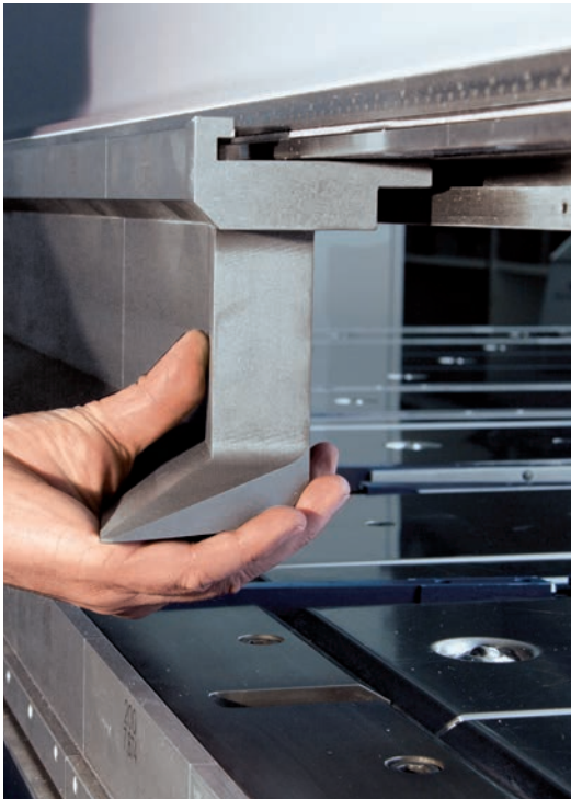
Die optionale hydraulische Werkzeugklemmung an der Oberwange verkürzt Rüstzeiten.
