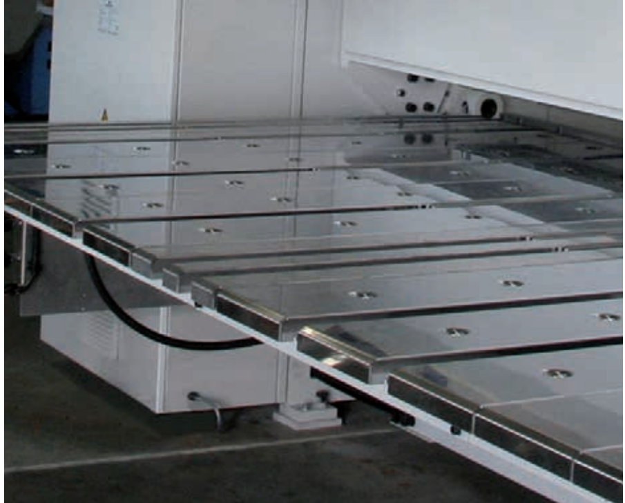
1 600-mm-Anschlag geschlossen mit Kugelrollen im Tisch
