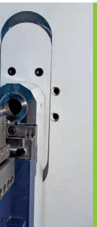
Mit einem optionalen verstärkten Antrieb der Biegewange kann die Biegeleistung um einen weiteren Millimeter Blechstärke gesteigert werden.
