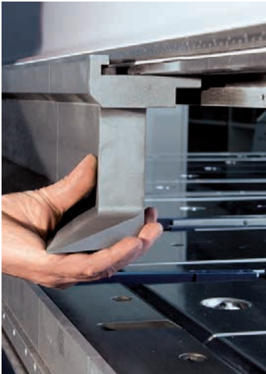
Die optionale hydraulische Werkzeugklemmung verkürzt Rüstzeiten.
