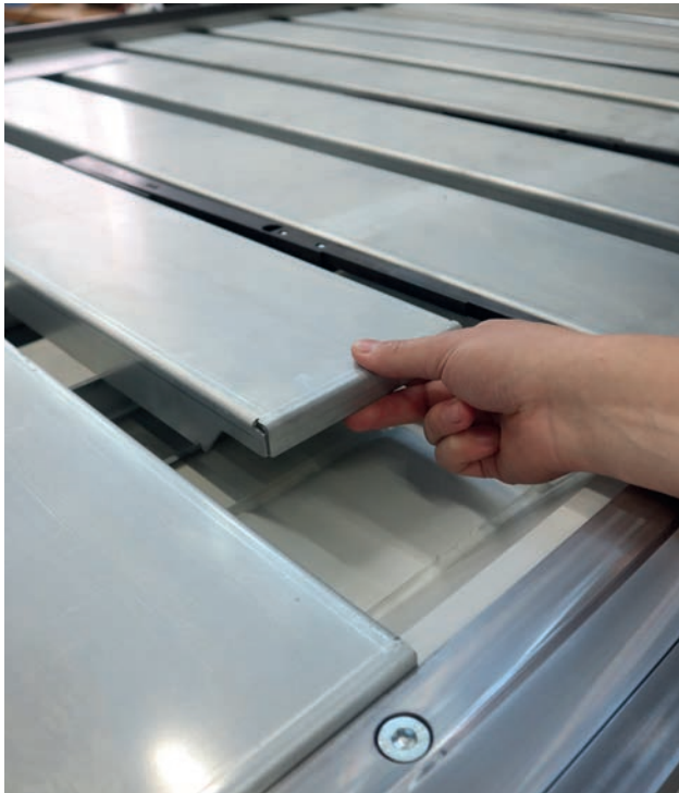
Standard: Herausnehmbare Auflagebleche, rückziehbar auf 337 mm.
