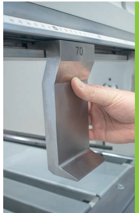
Option: Werkzeug-Schnellklemmung für den raschen und präzisen Werkzeugwechsel.
