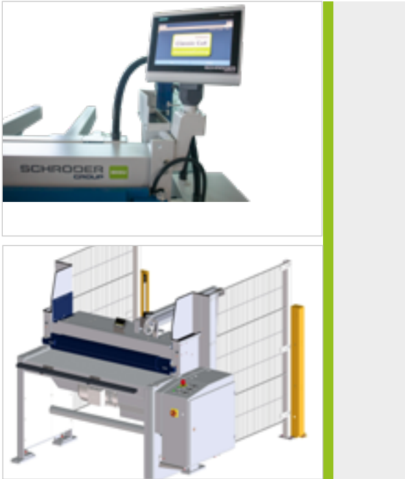
Standard: MHSU mit Rückraumabsicherung über 3-strahlige Lichtschränke incl. seitlichem Schutzgitter und manuellem Hinteranschlag.
