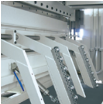
Pneumatisch gesteuerte Blechhochhaltevorrichtung
