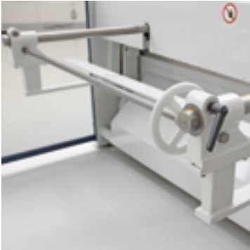
Manueller Hinteranschlag, Verstellbereich 10 - 600 mm
