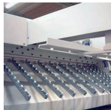
Blechhochhaltevorrichtung pneumatisch gesteuert mit Rollenleisten
