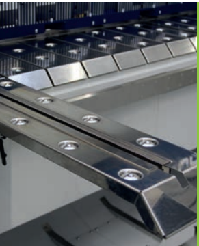
Verschiebbare Tischverlängerung auf Führungsschiene montiert
