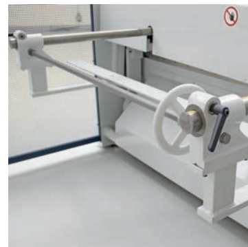
Manueller Hinteranschlag, Verstellbereich 10 - 600 mm
