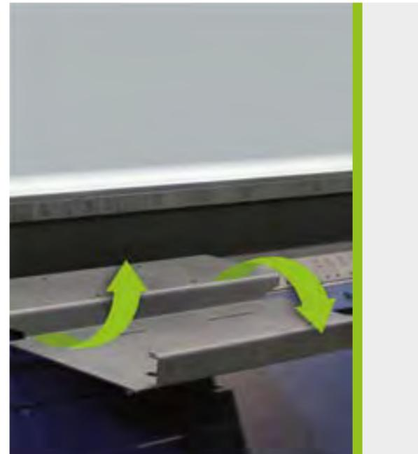
Die Up-and-Down Biegewange erlaubt Gegenkantungen in einem Arbeitsschritt.
