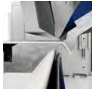
Querschnitt: Oberwangen-, Unterwangen- und Biegewangenwerkzeuge der oberen Biegewange
