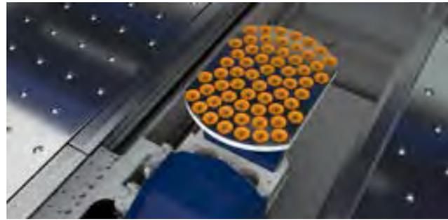
Option: Der Drehteller Anschlag „AHS“ ist ein vollautomatisches Advanced Handling System mit Kamerasystem zum Vermessen der Blechkontur.
