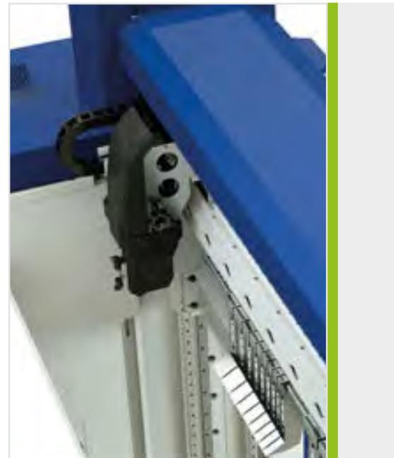
Optional vollautomatischer Werkzeugwechsel an der Oberwange für max. Werkzeughöhe 500 mm
