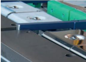
Untervangenschiene mit Fingereinfräsungen
