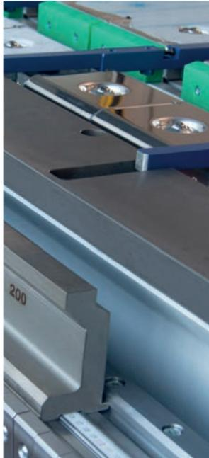
Untervangenschiene mit Fingereinfürungen und Biegeschielen
