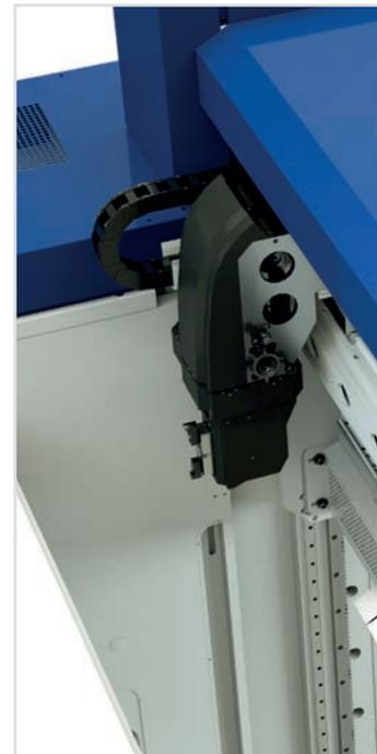
Optional vollautomatischer Werkzeugwechsel an der Oberwanne für max. Werkzeughöhe 500 mm
