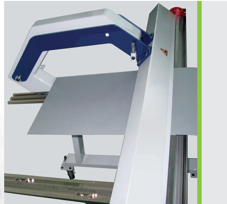
Variable Anschläge sorgen für Präzision.
