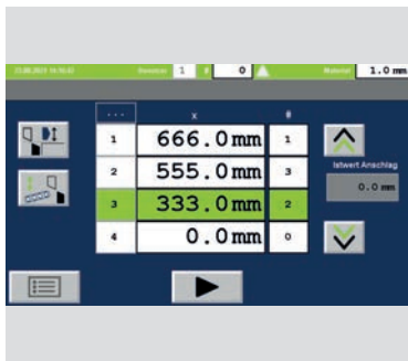
NC-Positionieranschlag Classic Cut mit 9-fach Programm
