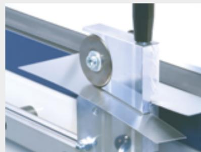
Mit dem Schneidkopf wird Blech leicht und sicher geschnitten.
