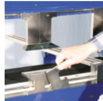
Patentierter Exzenter-Schnellklemmung für Ober- und Biegewange
