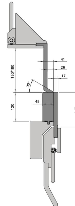
Querschnitt Werkzeug: hohe Ausführung an Oberwange, Biegewange und Unterwange
