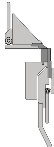
Querschnitt Werkzeug: Spitzschiene 20°/30° bzw. Rundschiene R 2/3/4/5
