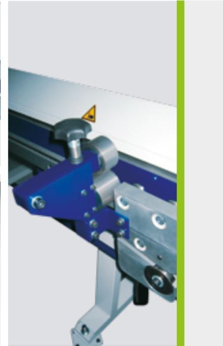
Der Multifunktionskopf schließt z.B. Umschlagkantungen
