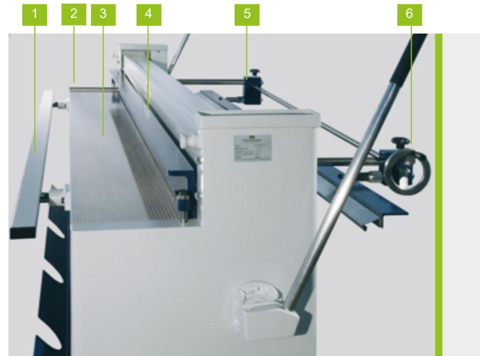
Manueller Hinteranschlag mit Skala und Handradverstellung [6] für parallele und konische Schnitte. Die Einstellung wird an den Winkelführungen [5] durchgeführt.
