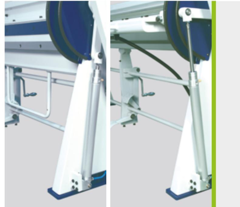
Die pneumatische Biegehilfe wird über einen Fingerhebel am Biegewangenbügel gesteuert.
