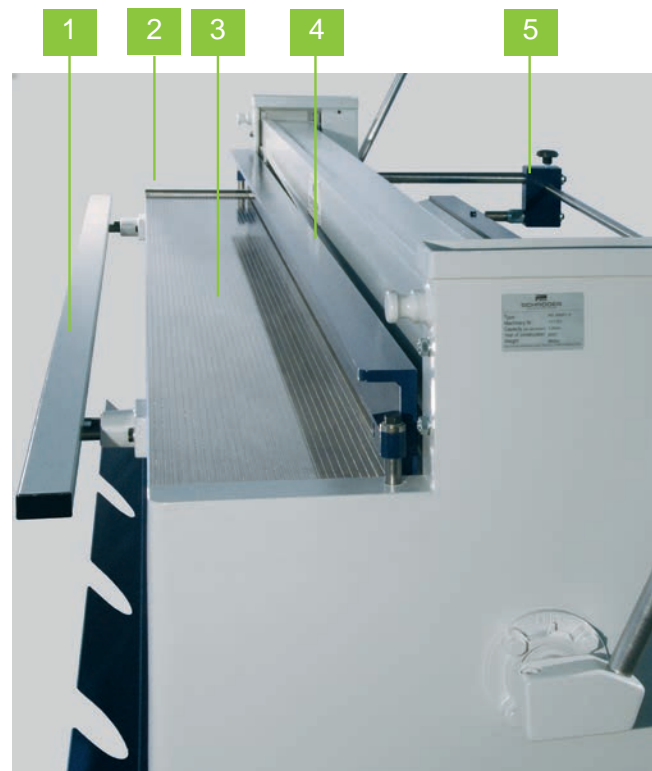
Manueller Hinteranschlag mit Skala und Handradverstellung [6] für parallele und konische Schnitte. Die Einstellung wird an den Winkelführungen [5] durchgeführt.
