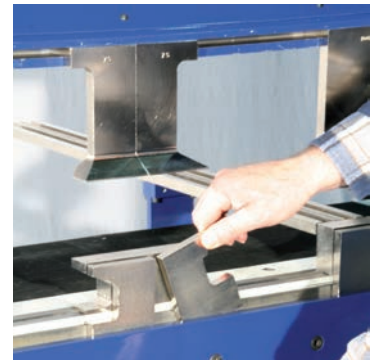
Patentierter Exzenter-Schnellklemmung für Ober- und Biegezwinge
