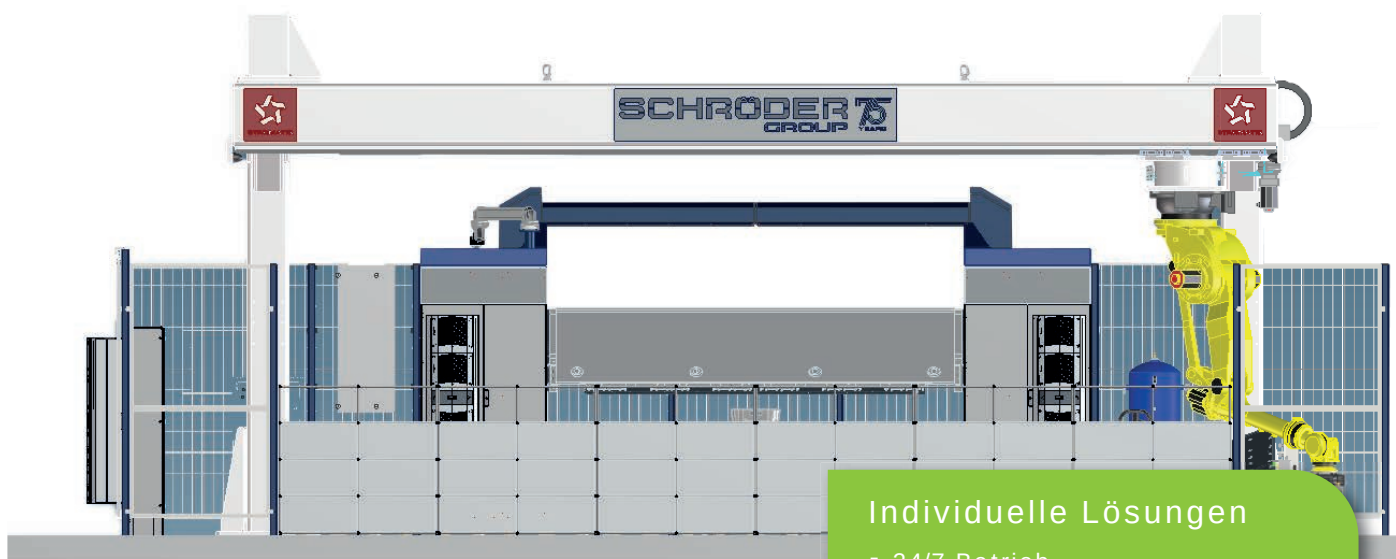
Frontansicht Roboter Handling System mit integrierter Schwenkbiegemaschine MAK 4 Evolution UD: Nutzlänge x Blechstärke 3200 mm x 6,0 mm
