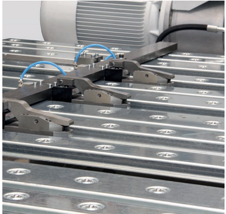
Kugelrollen im Tisch für leichteres Positionieren.
