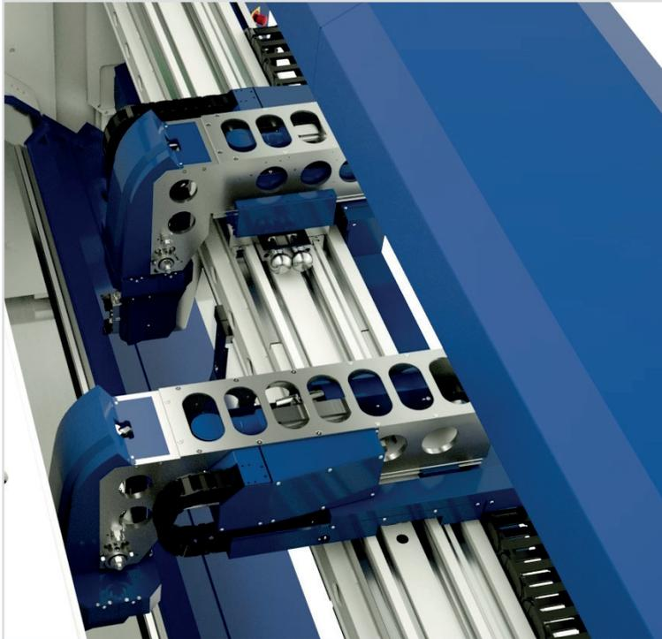
Zwei asynchron verfahrbare Werkzeugwechsler verfügen über je eine Greifeinheit.
