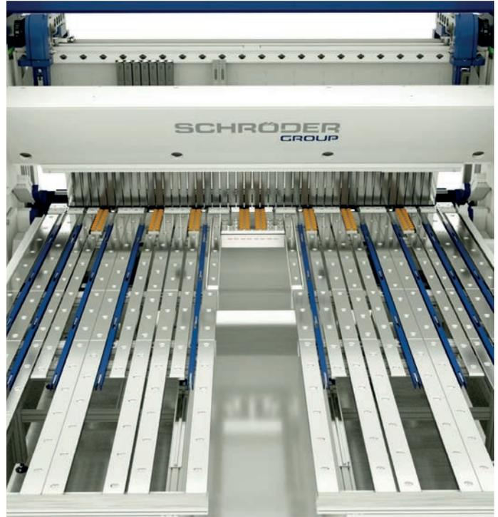
Hinteranschlag in U-Form mit Saugplatten im Tisch, gesteuert über POS 3000.
