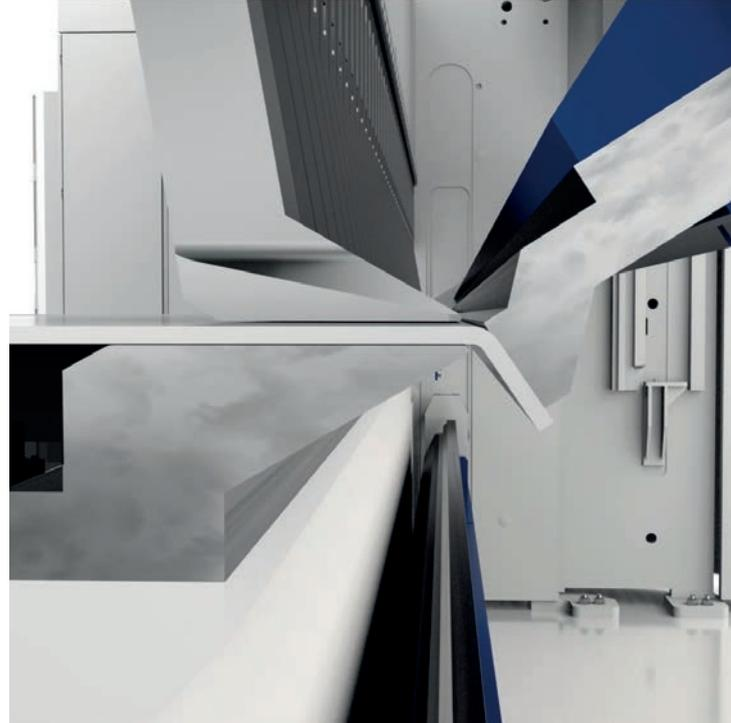
Querschnitt: Oberwangenwerkzeuge, Unterwangenwerkzeuge und Biegewangenwerkzeuge der oberen Biegewange
