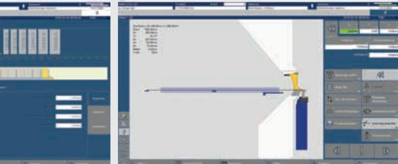
Oben: Die 3D-Darstellung erleichtert die Bemaßung. Unten: Die Biegesituation in 2D-Darstellung
