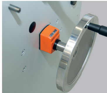
Standard: Digitale Siko-Anzeige für die manuelle Unterwalzenanstellung für die Blechdickeinstellung, optional auch motorisch erhältlich.
