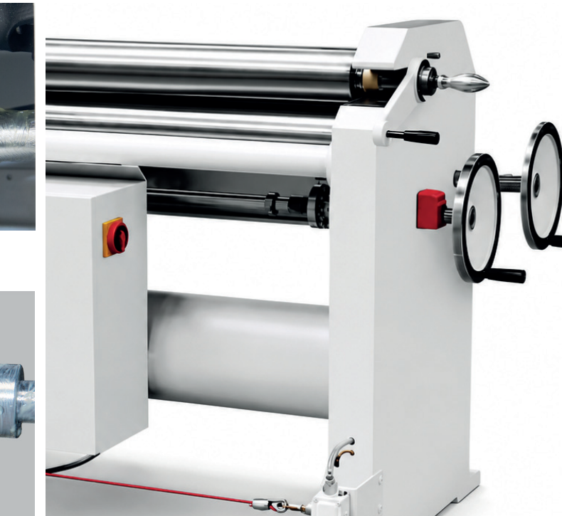
Standard FM 1R Steuerung: Unter- und Hinterwalze werden manuell über das Handrad verstellt. Der Antrieb der Walzen erfolgt motorisch über einen Fußtaster.
