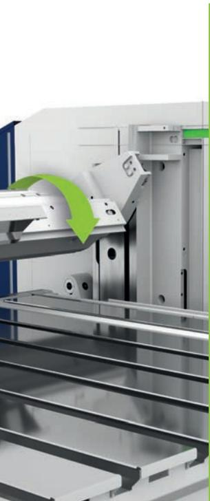
Mit der drehbaren Oberwange hält die PBM ein zweites Set für bis zu 170 mm hohe Werkzeuge parat.
