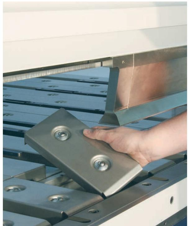
Herausnehmbare Auflagebleche, rückziehbar auf 337 mm.
