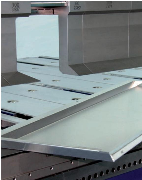
NEU: Oberwangenhub von 500 mm für Produkthöhen bis 250 mm.
