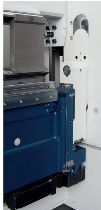
Biegewangenabsenkung mit Servoantrieb und Kugelumlaufspindeln sowie servogesteuerte Drehmittelpunktverstellung.
