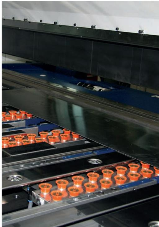
Saugplatten im Anschlagtisch mit 6 Saugeinheiten, programmgesteuert incl. Anschlag gegen Biegewange (nur bei Up and Down)
