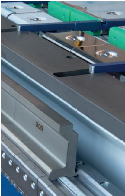
Untervangenschiene mit Fingereinfürungen
