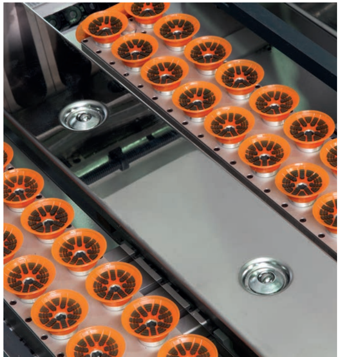
Saugplatten im Anschlagtisch, gesteuert über POS 3000.
