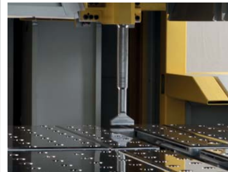
Sonderlösungen Oben: Entnahme nach hinten mit Rollentisch Unten: Ein von hochpräzisen Kamerasystemen kontrollierter Manipulatorstempel richtet das Blech in der Maschine aus.
