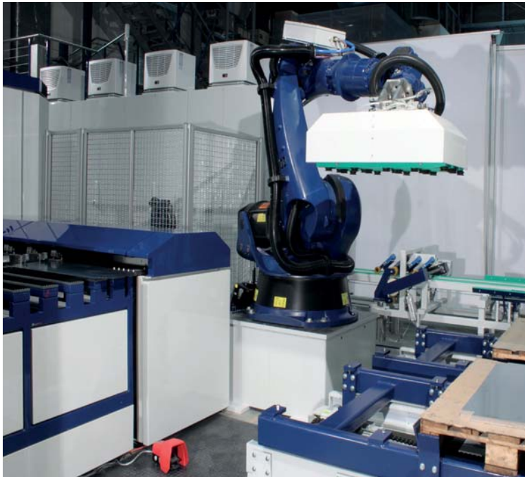
Eingesetzter Kuka-Roboter: Das Blech wird per Vakuumeinheit angesaugt
