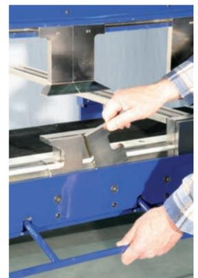
Patentierte Exzenter-Schnellklemmung für Ober- und Biegewange
